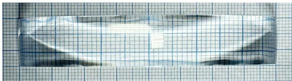
Коришћењем ових фотографија и анализом одговарајућих апсолутних грешки, насталих као резултат очитавања са mm-папира, проценити бројне вредности индекса преламања акрила  $n$ , као и висине  $h$ . Објектив фотоапарата није постављен близу површине полуудиска. . . . . (⊗⊗)
